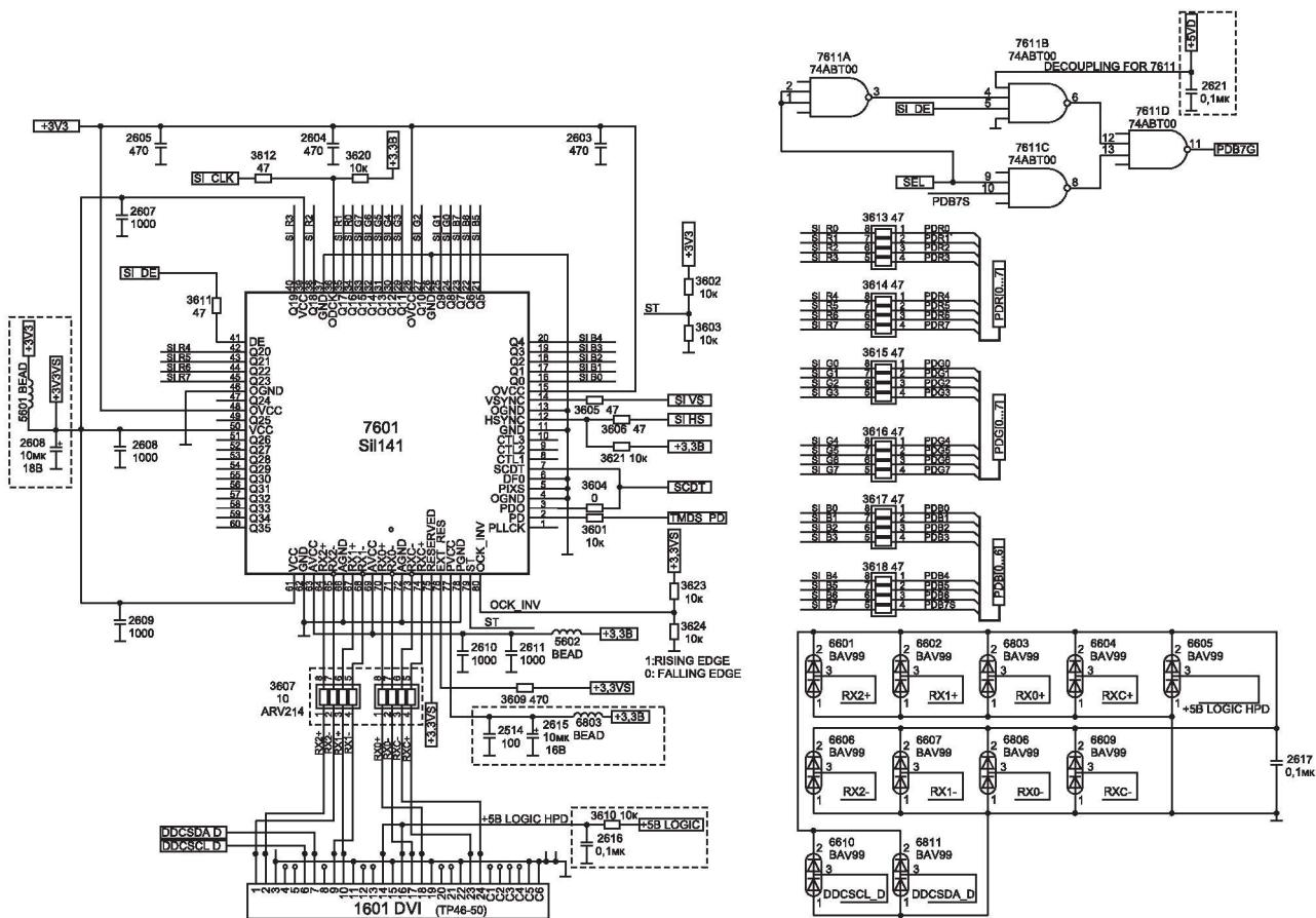
*Рис. 6. 11. Контроллер цифрового интерфейса DVI*
