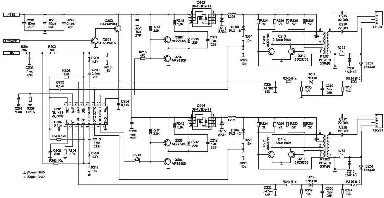
**Рис. П2.** Принципиальная электрическая схема инвертора фирмы SAMPO. Инвертор устанавливается в 17-дюймовые мониторы LG, PHILIPS, SAMSUNG в которых используются ЖК панели LG-PHILIPS, SANYO.
