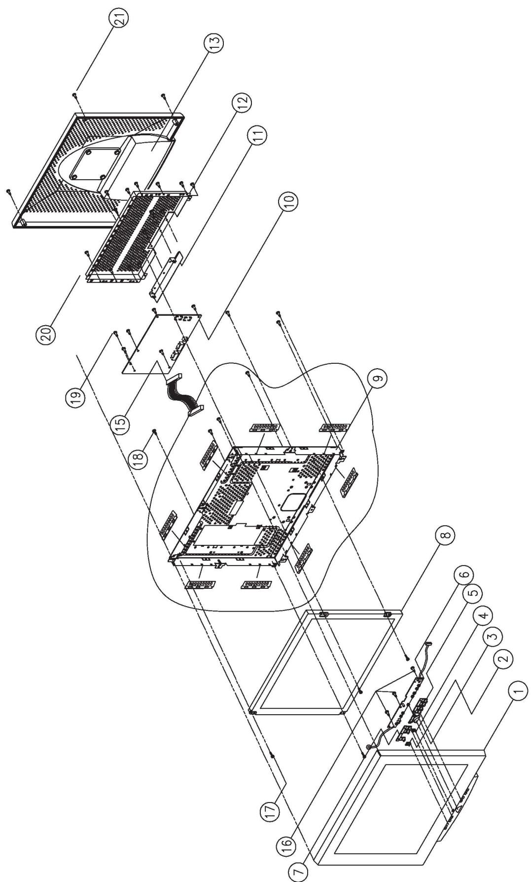
Рис. 8.1. Конструкция монитора «Samsung SyncMaster 800 TFT»
