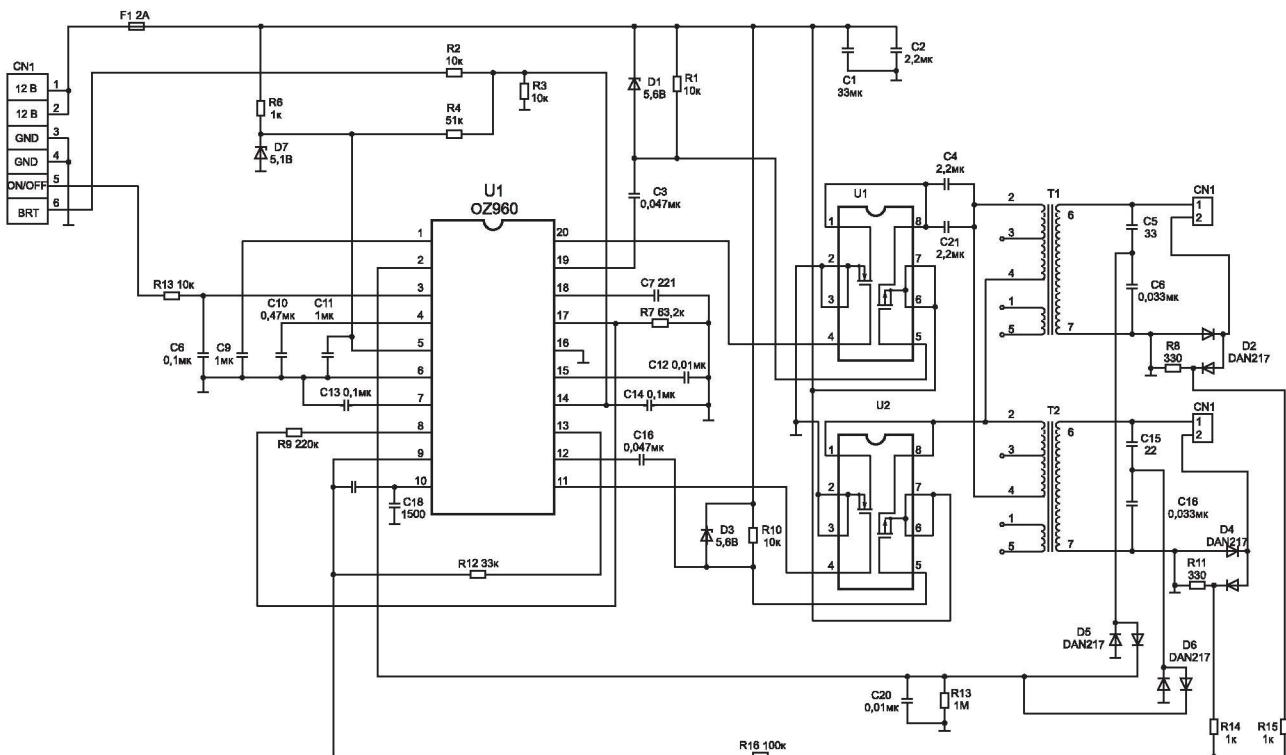
Рис. П4. Принципиальная электрическая схема инвертора фирмы TDK. Инвертор устанавливается в 17-дюймовые мониторы SAMSUNG, в которых используются ЖК панели SAMSUNG. Характеристики:  $U_{BX} = 12 \text{ В}$ ,  $U_{Выход} = 850 \text{ В}$ ,  $I_{Выход} = 8 \text{ мА}$  (в каждом канале)
