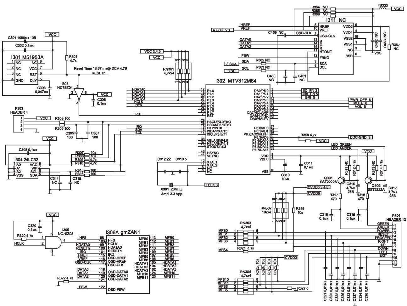
Рис. 5.5. Микроконтроллер, OSD и ЭСППЗУ
