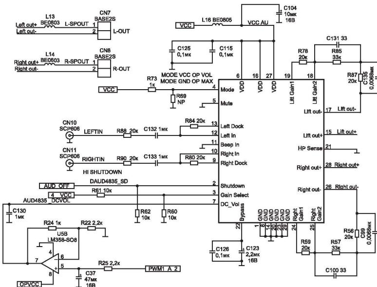
Рис. 1.7. Усилитель звуковой частоты APA4835
