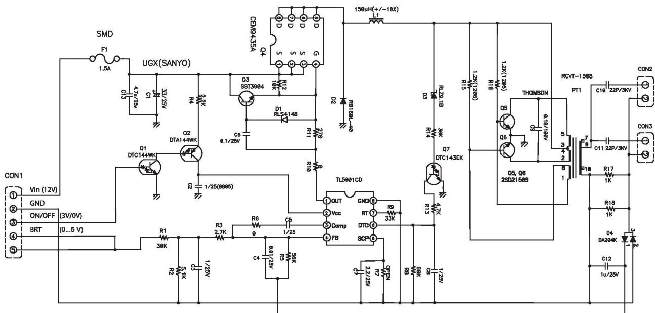
П6. Принципиальная электрическая схема инвертора DIVTL 0048-D21 фирмы SAMPO. Инвертор устанавливается в 15-дюймовые ЖК матрицы с двумя лампами подсветки. Характеристики:  $U_{BX} = 10,8 \dots 13,2 \text{ В}$ ,  $I_{BX} = 800 \dots 1300 \text{ мА}$ ,  $I_{вых} = 2,2 \dots 6,2 \text{ мА}$  (в каждом канале),  $U_{вых} = 580 \dots 780 \text{ В}$
