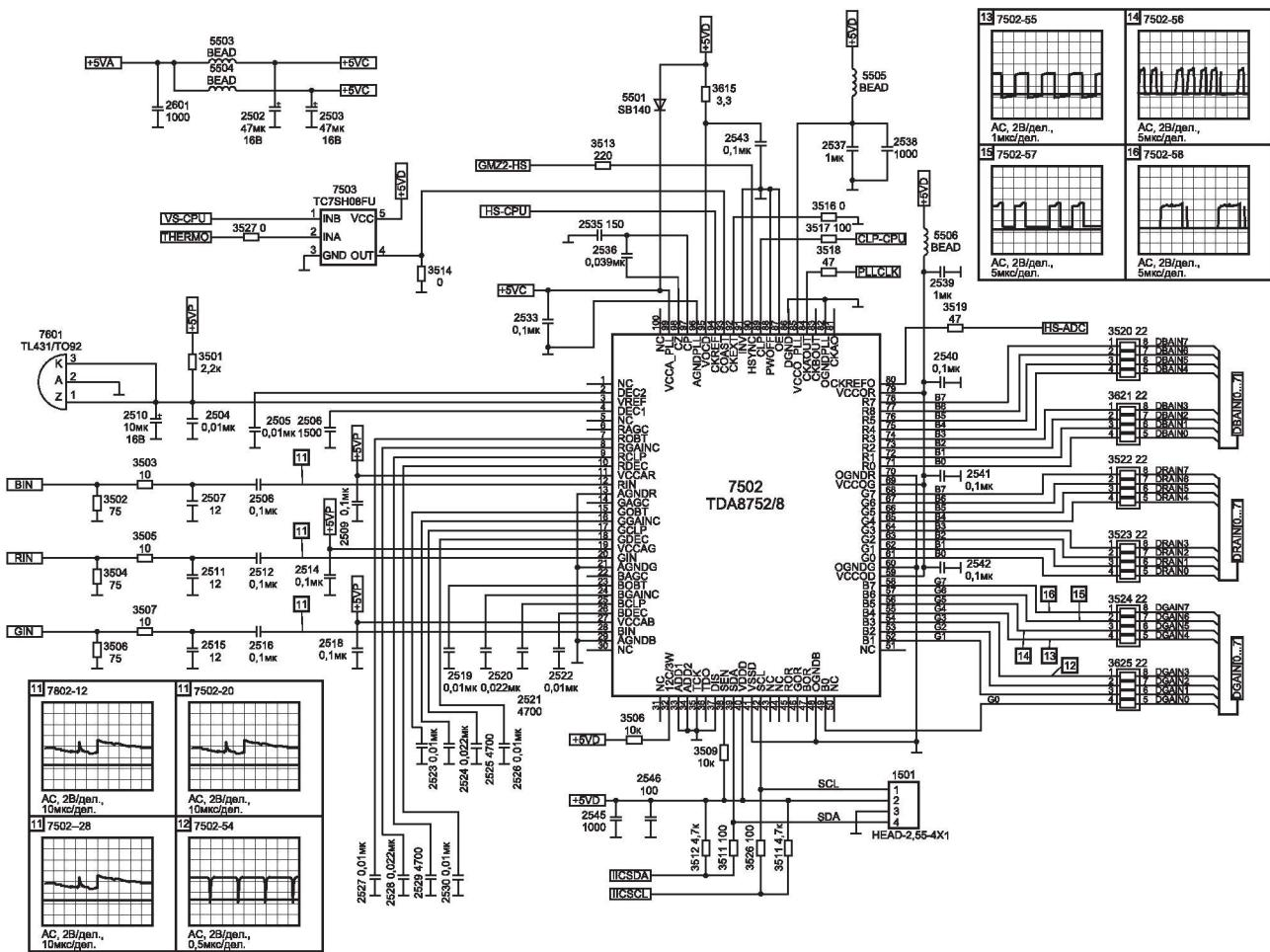
*Рис. 6.12. Аналого-цифровой преобразователь*
