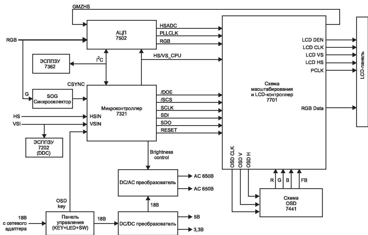
Рис. 6.2. Структурная схема монитора Philips 150B
