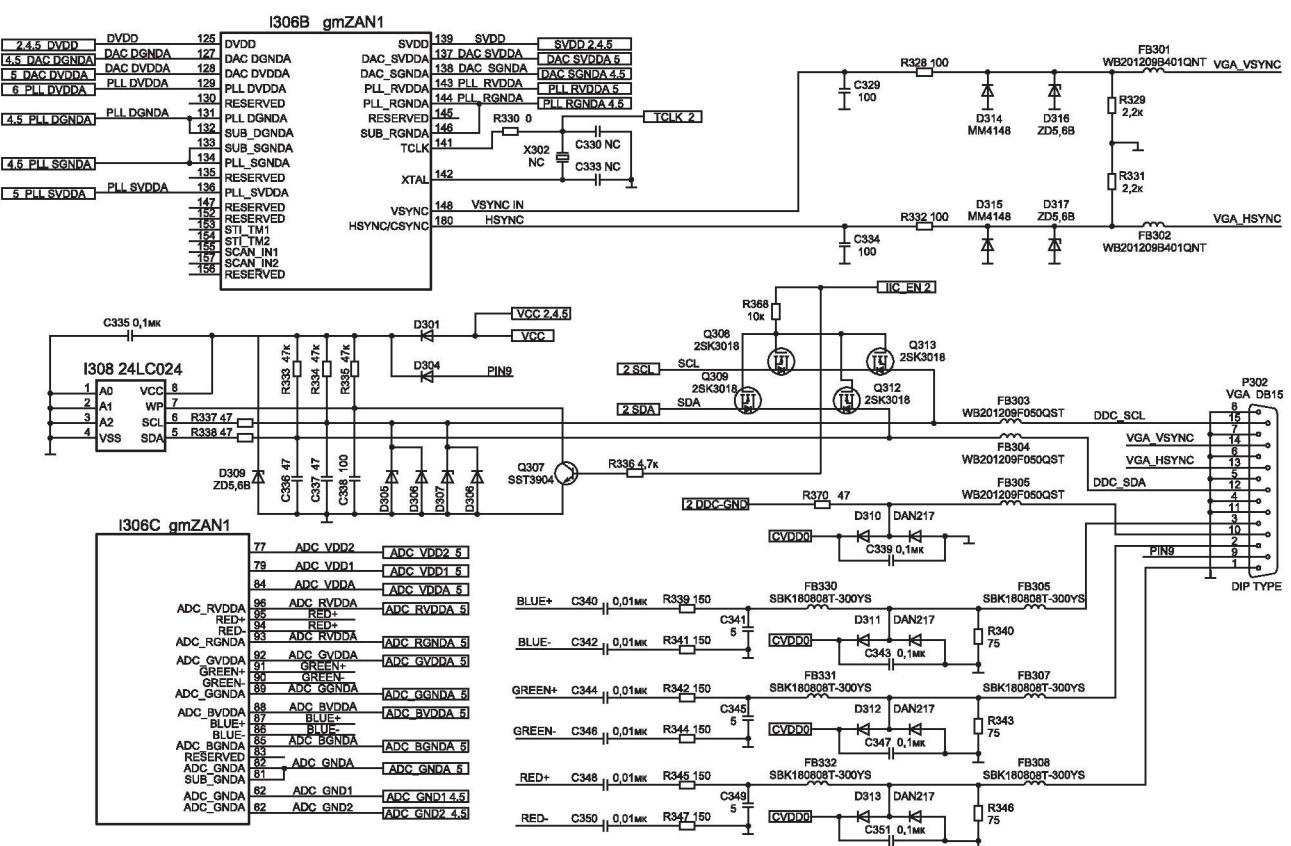
Рис. 5.6. Входной интерфейс и узел синхронизации. АЦП
