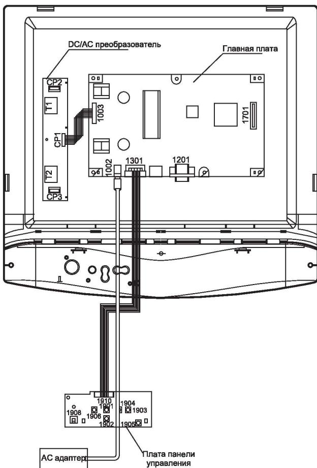
Рис. 6.4. Схема соединений монитора Philips 150B
