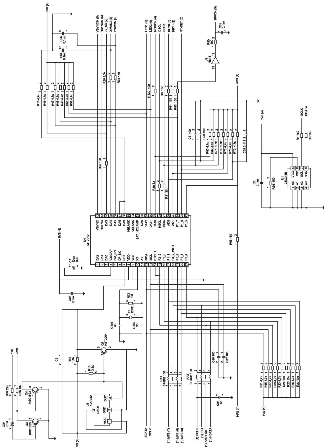
Рис. 4.11. Микроконтроллер и ЭСППЗУ
