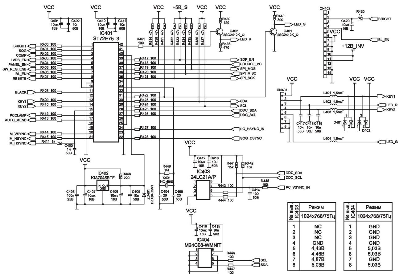
Рис. 7.6. Микроконтроллер и ЭСПЛЗУ
