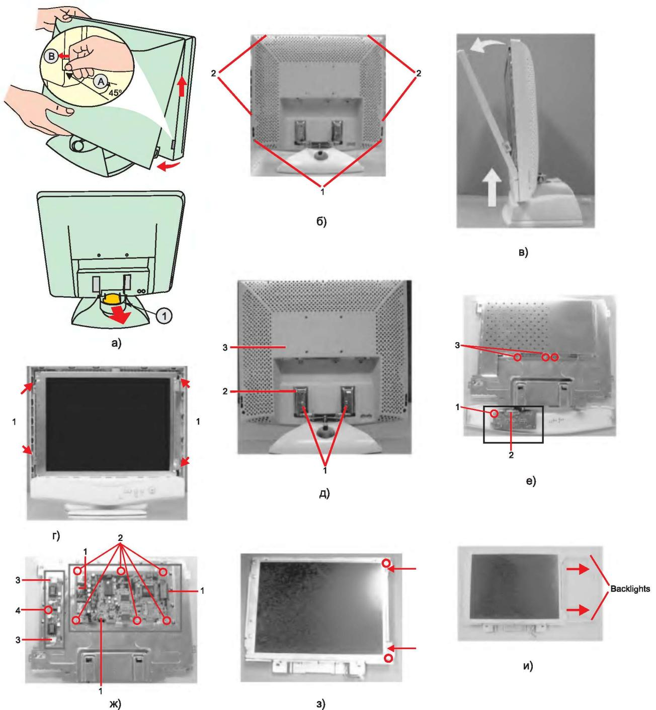
Рис. 6.3. Схема разборки монитора Philips 150B
