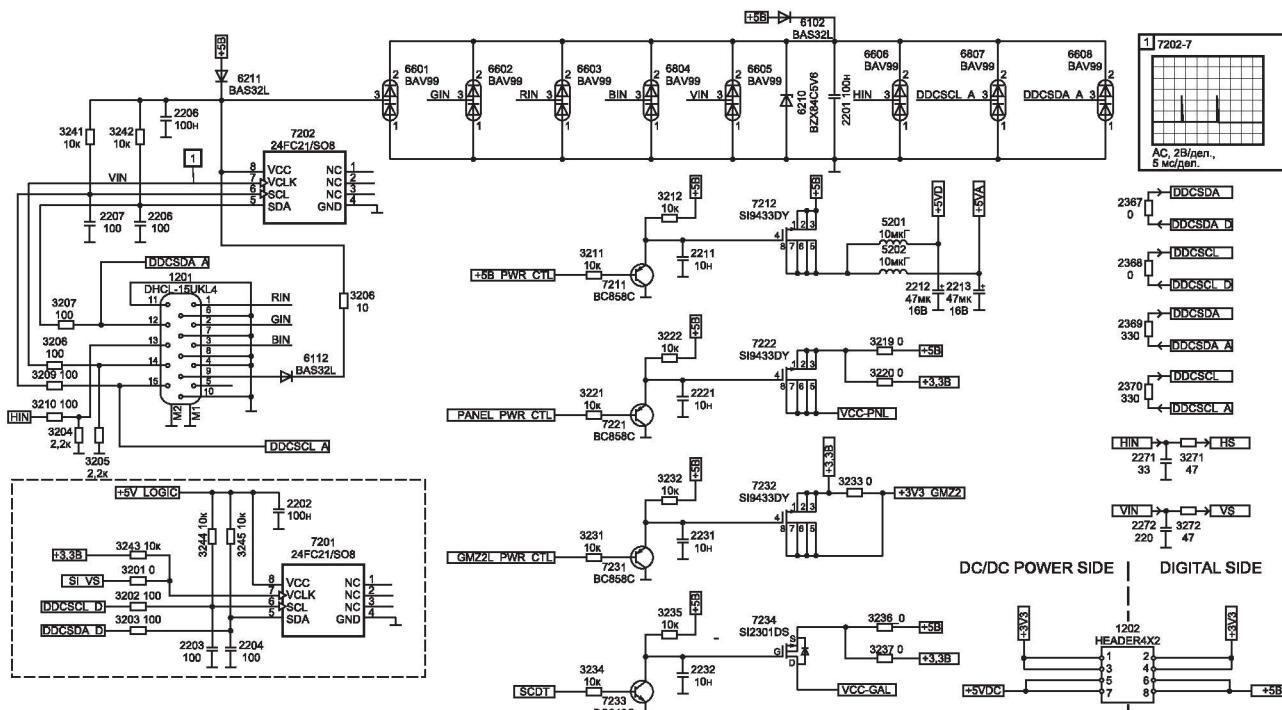
Рис. 6.7. Транзисторные ключи, ЭСППЗУ, интерфейсный соединитель
