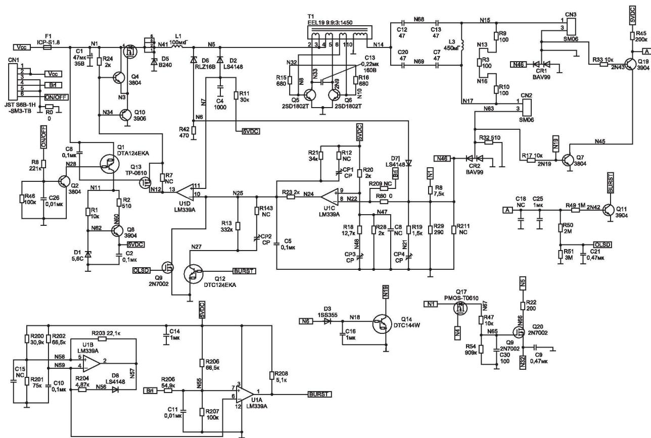
Рис. 5.4. DC/AC-преобразователь для питания ламп подсветки
