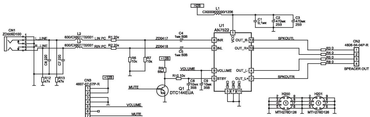
Рис. 2.14. Усилитель звуковой частоты
