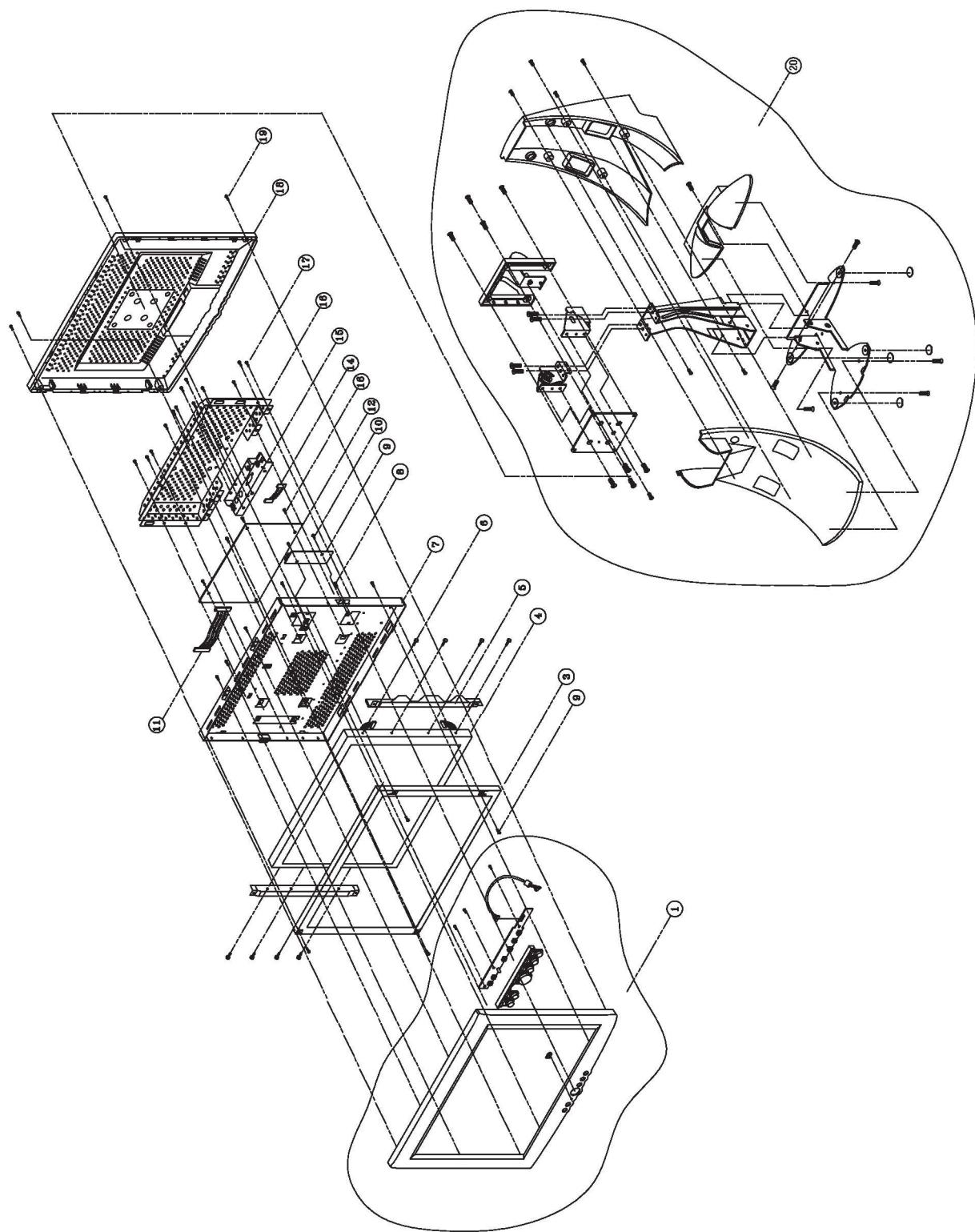
Рис. 7.1. Конструкция обычного монитора
