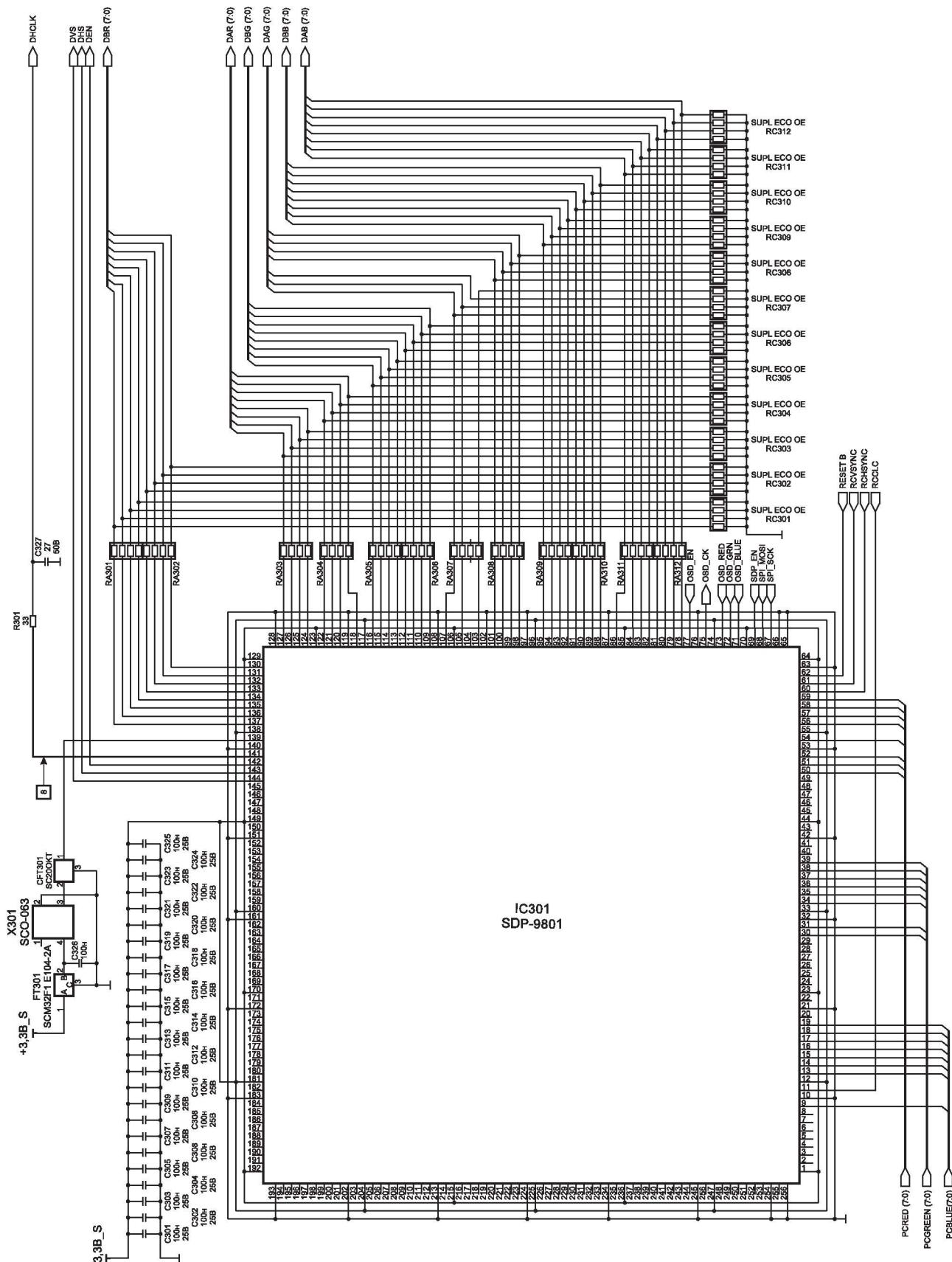
Рис. 7.8. Схема масштабирования и LCD-контроллер
