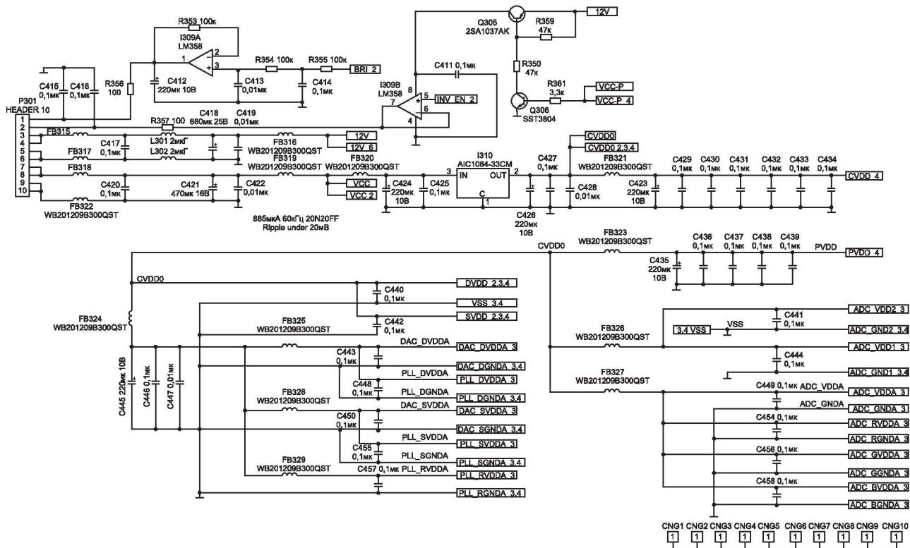
Рис. 5.3. Стабилизатор 3,3 В и развязывающие фильтры
