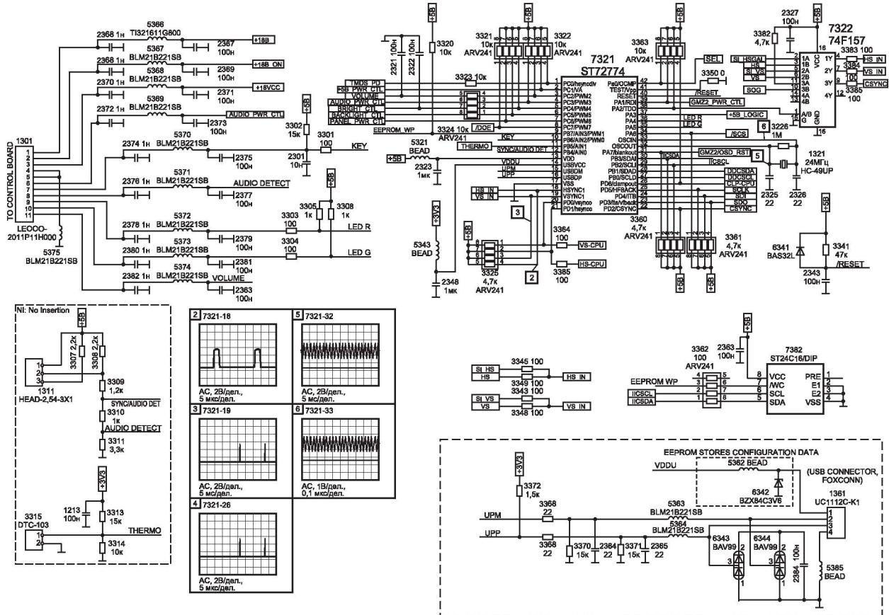
Рис. 6.9. Микроконтроллер
