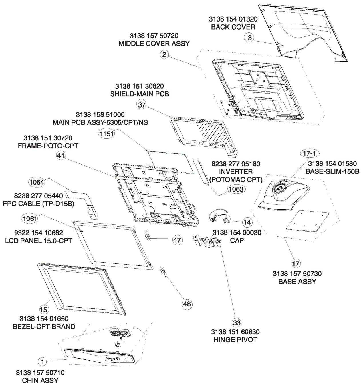
Рис. 6.1. Конструктивные узлы монитора Philips 150B
