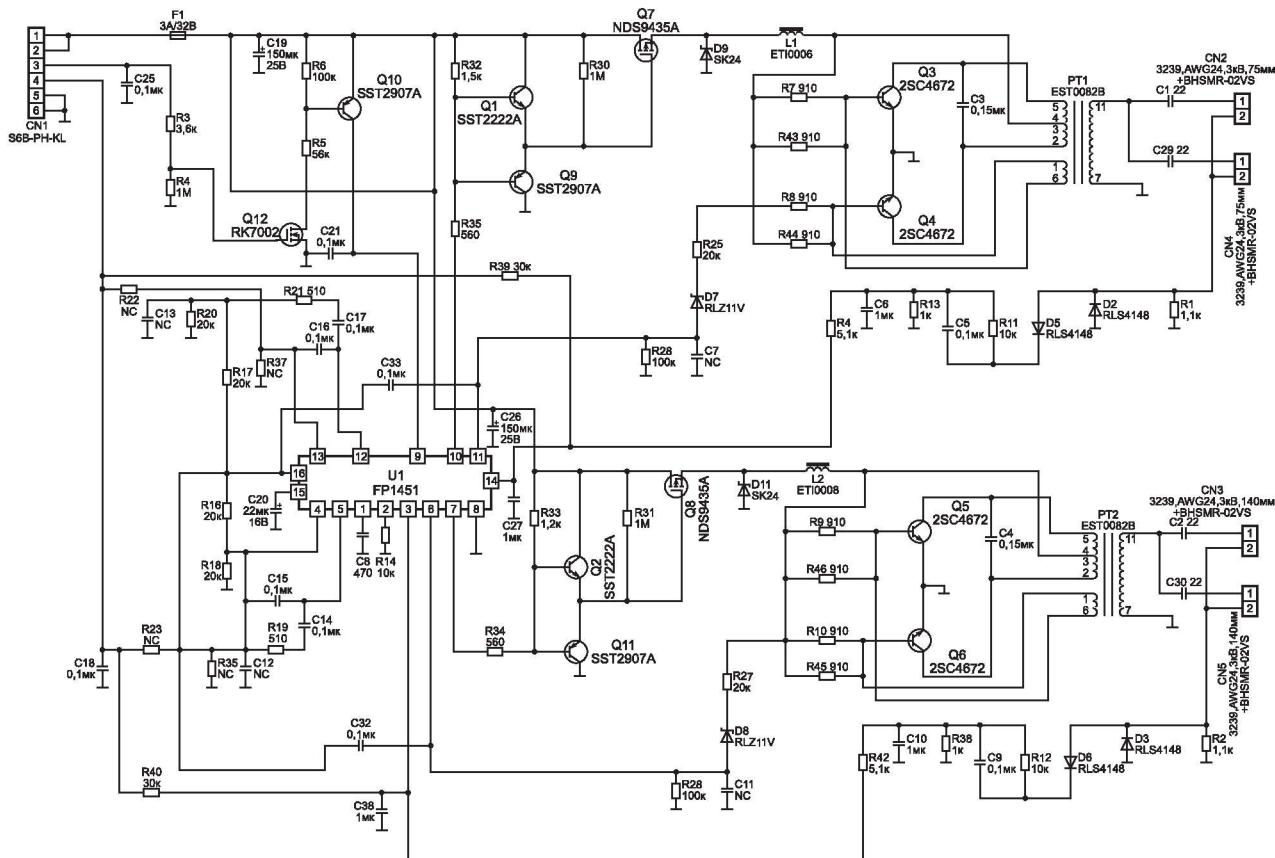
Рис. 2.8. DC/AC-конвертор
