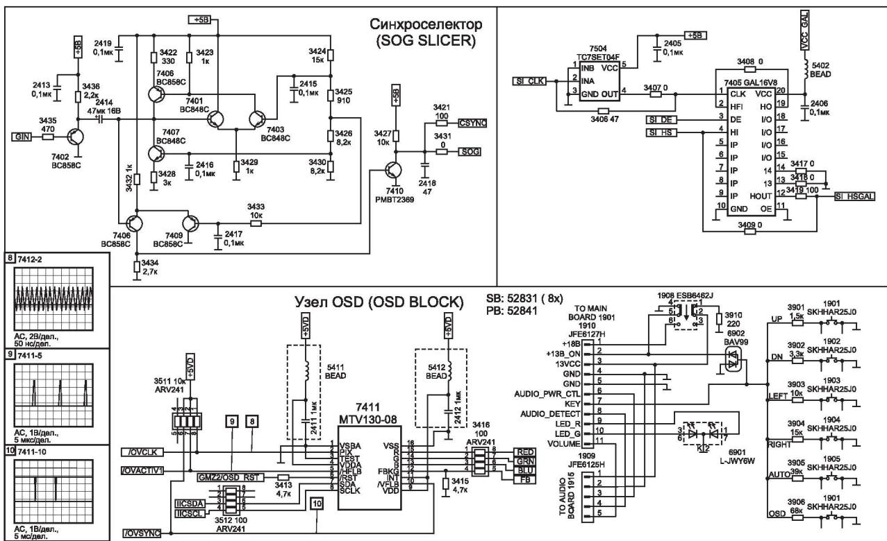
Рис. 6.6. Схема OSD, синхроселектор, панель управления
