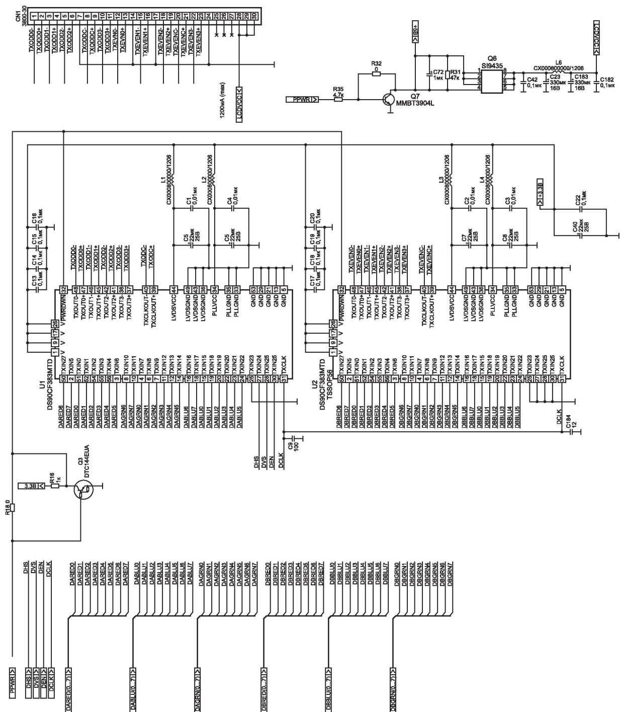
Рис. 2.13. Интерфейс LCD-панели
