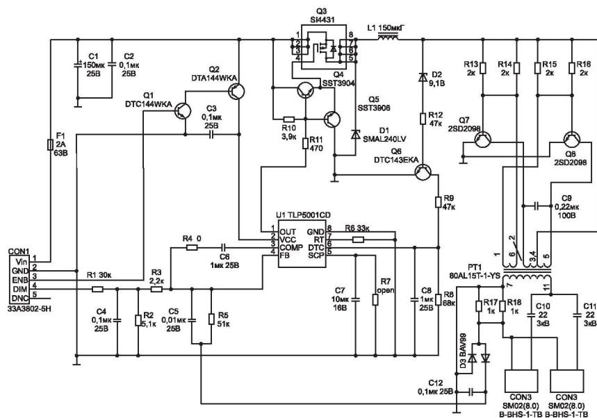
**Рис. П1.** Принципиальная электрическая схема инвертора типа PLCD2125207A фирм EMAX и SAMPO. Инвертор устанавливается в 14- и 15-дюймовые в мониторы Acer, AOC, BENQ, LG, Philips.
