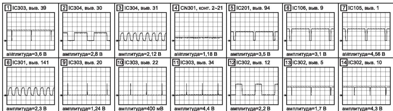
Рис. 7.7. Осциллограммы сигналов в контрольных точках схемы
