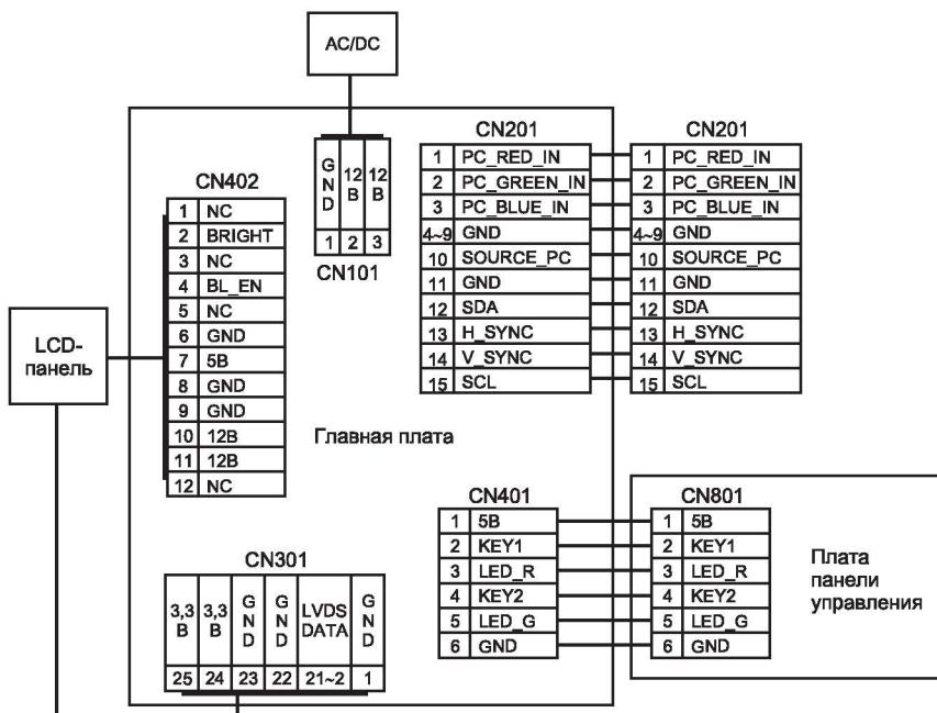
Рис. 7.4. Схема соединений
