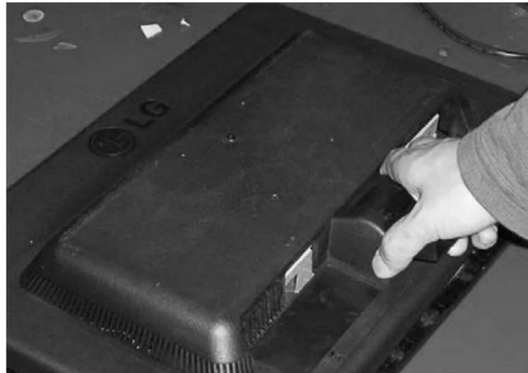
**Рис. 5.9. Снятие задней крышки**
