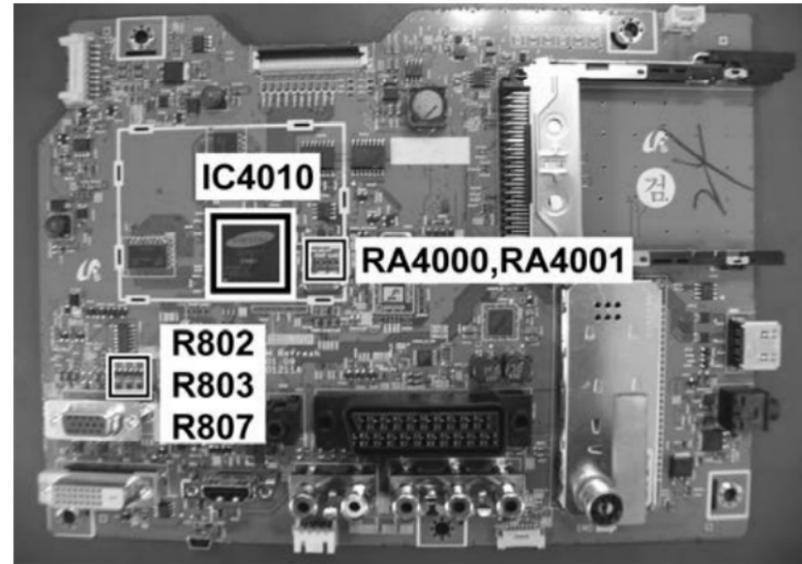
Рис. 6.18. Точки и элементы контроля на основной плате
